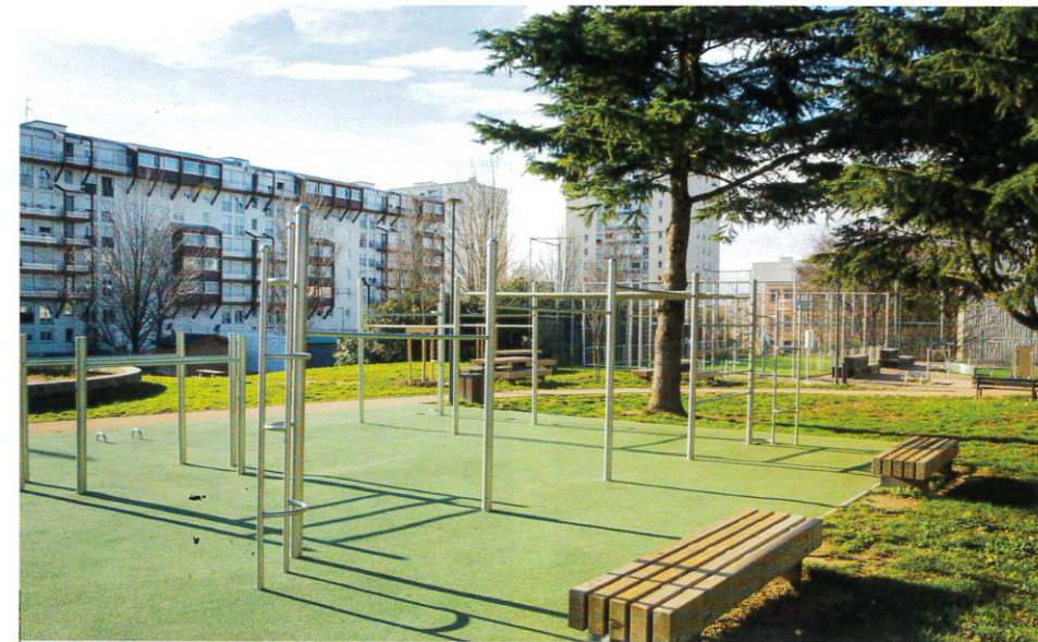
Les structures en acier galvanisé et en inox sont parfaitement adaptées à la pratique du street workout. Ici, des équipements Pro Urba, 'made in France' et composés d'inox 100 % recyclable.
