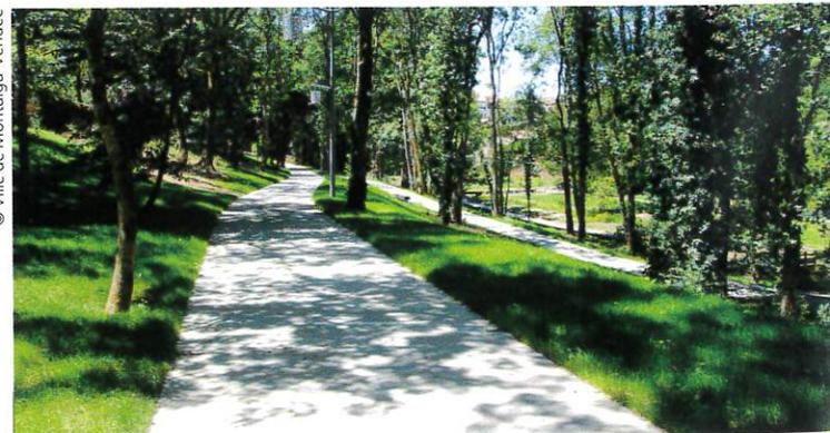
Des circulations en béton balayé de couleur claire, d'une largeur de 3 m, serpentent sur les versants et en fond de vallon. La pente est de 4 % afin d'offrir un cheminement confortable pour tout le monde.
