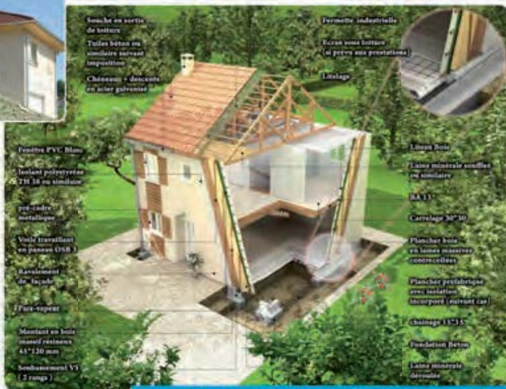
Coupe de principe d'une maison à ossature bois NATILIA
